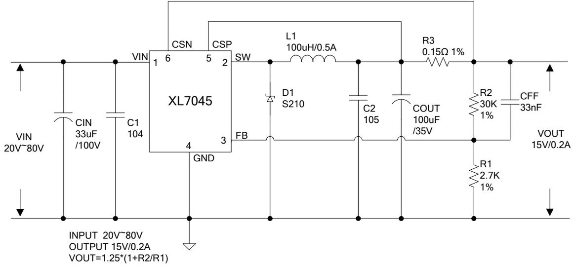
图 7. XL7045 系统参数测量电路 (VIN=20V~80V, VOUT=15V/0.2A)
