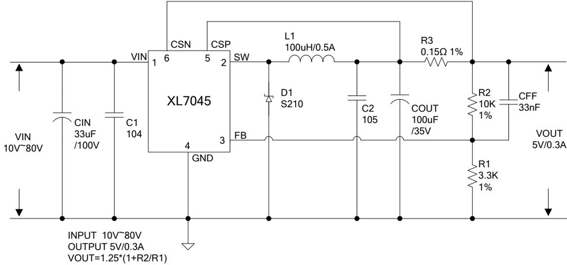
图 9. XL7045 系统参数测量电路(VIN=10V~80V, VOUT=5V/0.3A)
