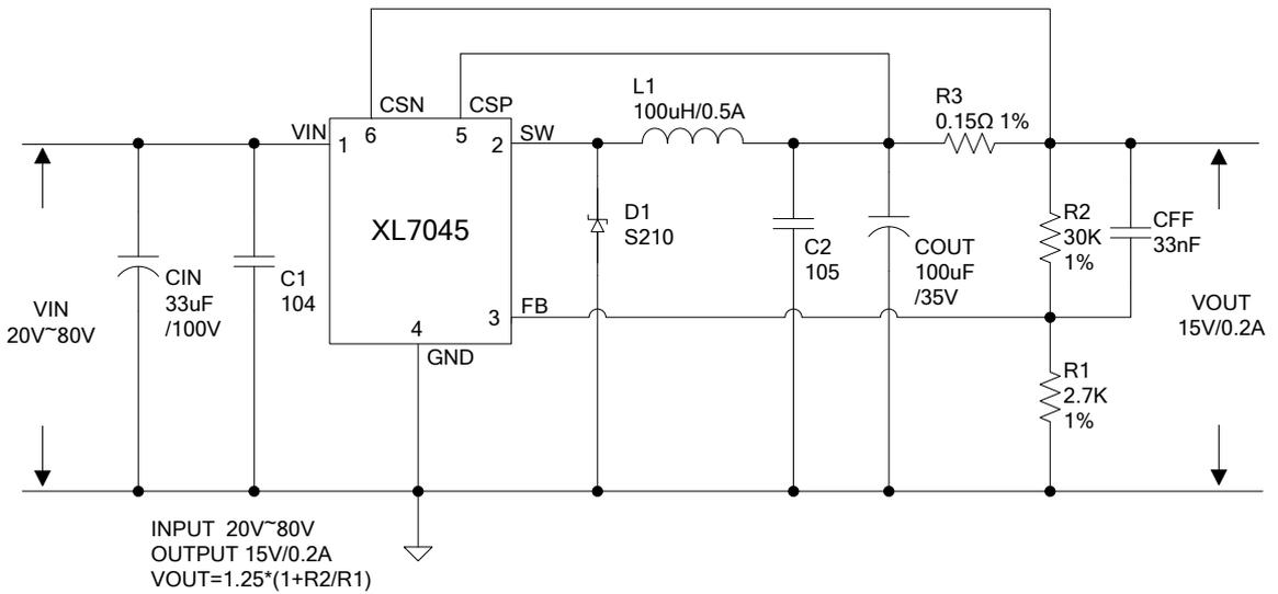
图 4. XL7045 系统参数测量电路
